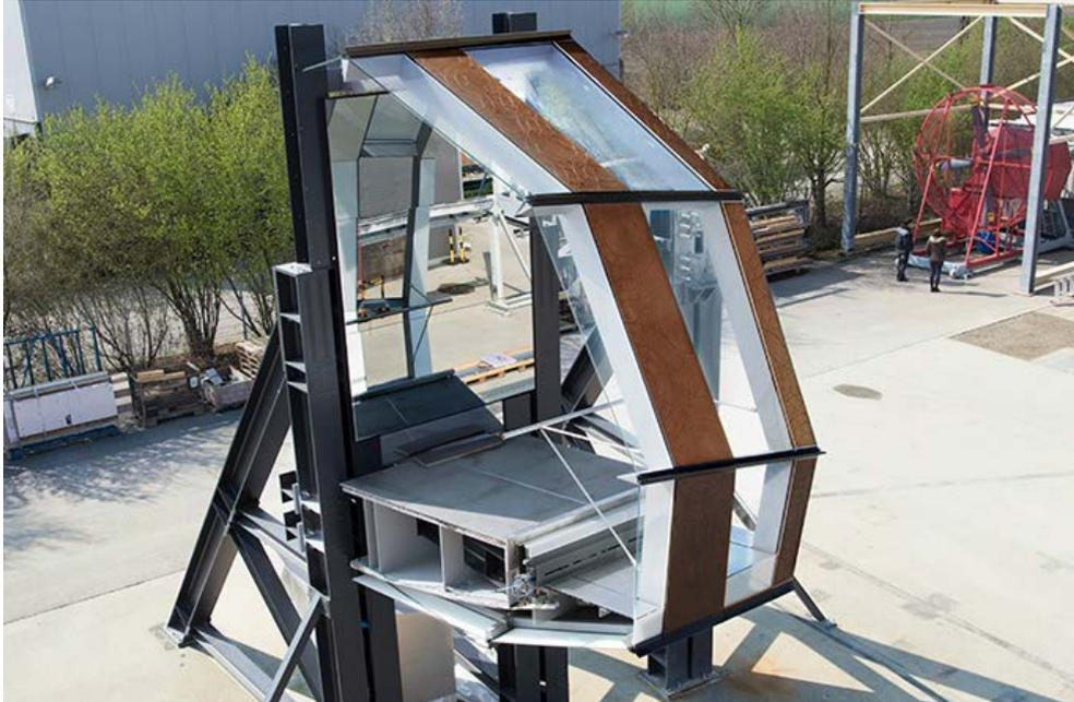
Mock-up-Aufbau auf dem Testgelände der seele GmbH in Gersthofen/Deutschland in einem vertikalen halbierten, 3m langen Ausschnitt. ©seele
