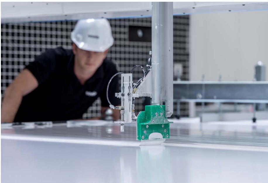
Silikonierung von Vordachscheiben. ©seele/René Müller
