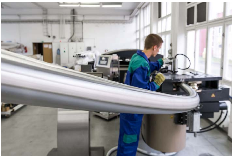
Selbstlernende Maschinen zur Biegung und Messung der Edelstahlrohre ©seele/René Müller
