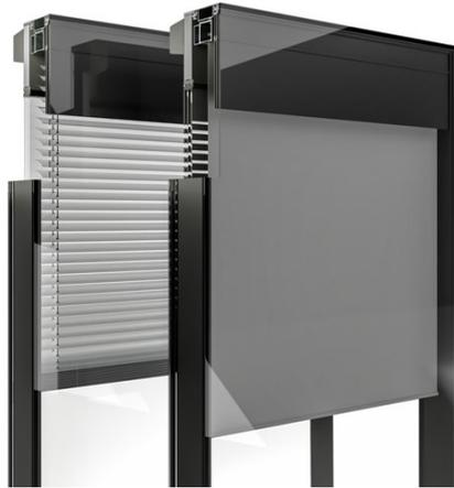
ISOshade® besteht aus einem 3-fach Isolierglas und einem Zwischenraum mit integriertem Sonnenschutzsystem – wahlweise ein Raffstore oder eine Senkrechtmarkise. © seele
